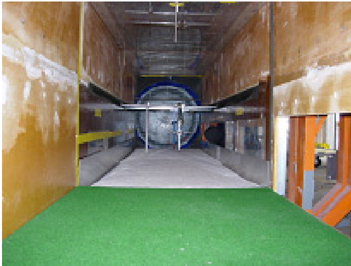
Abb. 1: Der Windkanal ermöglicht eine experimentelle Analyse der Wirkung von Windströmungen auf eine natürlich gefallene Schneedecke (Foto: Archiv SLF).
